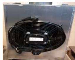
condensador de vapor v-28 acero
