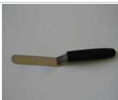
espátulita restauración curvada de codo
